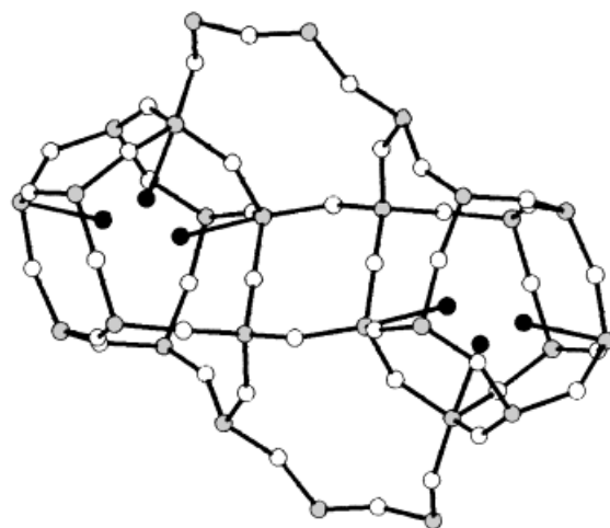
Abb. 1. Ansicht von zwei der charakteristischen Untereinheiten von SSZ-23 (Näheres siehe Text). Die Darstellung zeigt auch die Positionen der teilweise besetzten Fluorlagen in den kleinen Käfigen. Si-, O- und F-Atome sind als graue, weiße bzw. schwarze Kreise abgebildet.
